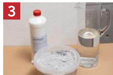
3 Mit dem Rührwerksmischer in sauberes Leitungswasser (ca. 0,9–1,3 l je nach Nuance auf 1 kg Trockenmasse) bzw. bei gegebener Kennzeichnung mit Anmachflüssigkeit einrühren.
