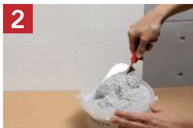
2 Trockenmasse von Hand durchmischen.
